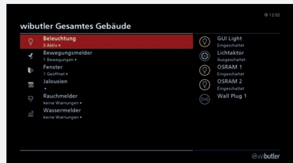
Raum- und Etagenübersicht ermöglicht Sensoren- und Aktoren-Zustandsanzeige
