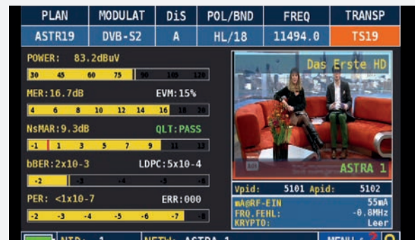
Übersichtliche Darstellung von Pegel, MER, Rauschreserve, Bitfehlerraten und zugehörigem Livebild
